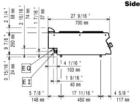
Electrical inlet (power) EQ Equipotential screw
