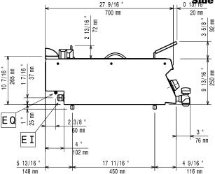
**EI** = Electrical inlet (power) **EQ** = Equipotential screw
