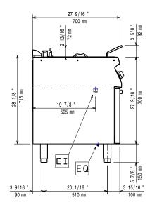
**EI** = Electrical inlet (power) Equipotential screw
