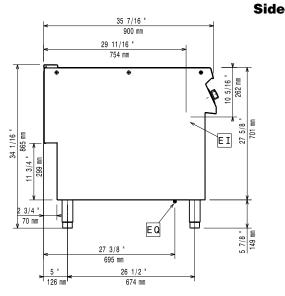
Electrical inlet (power) Equipotential screw
